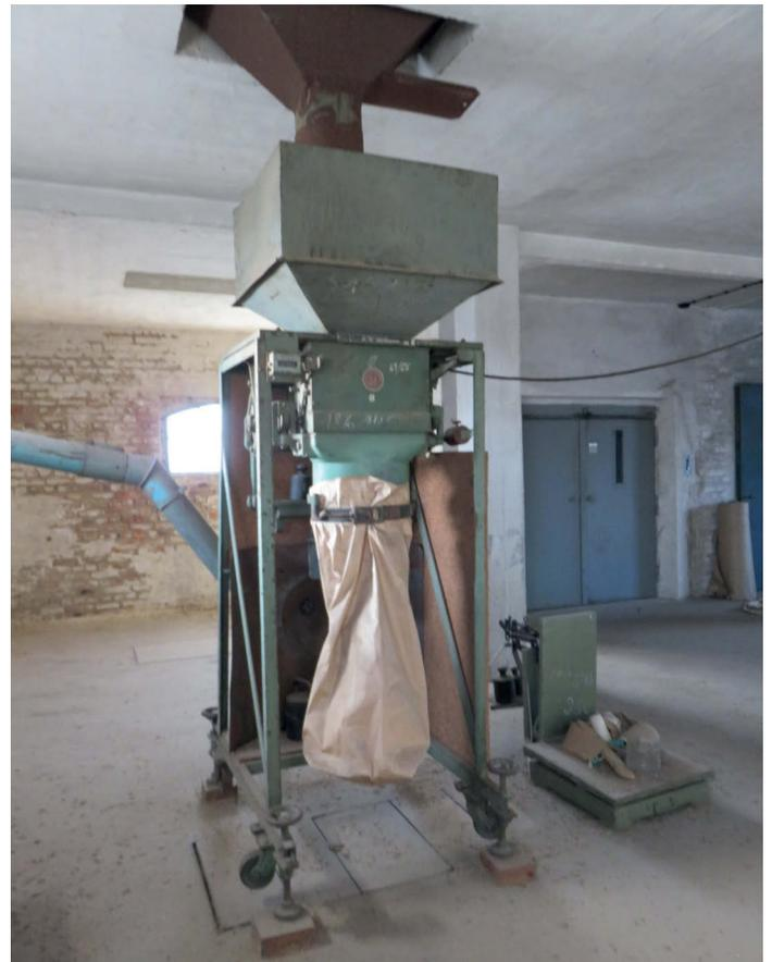
Automatische Getreidewaage für Säcke
